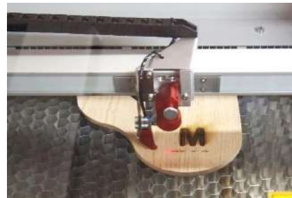
(図 11) 文字のレーザー彫刻。木材は表面を 焦がすことで濃い色の表現ができる。
