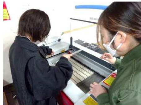
(図 14) レーザー加工機で図書の項目のプレートを加工する。
