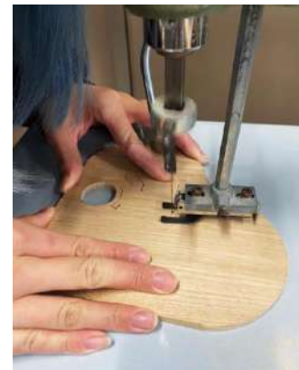
(図 9) 木材を糸鋸盤で切り 抜く。レーザー加工では焦 げるため、手で仕上げる。
